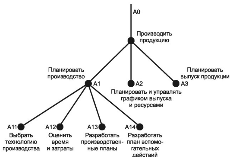
Рисунок 3.23 — Пример дерева узлов [16]
