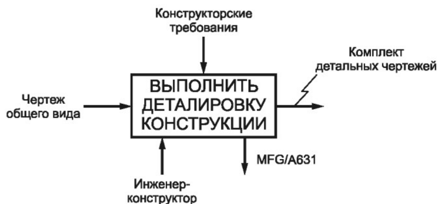
Рисунок 3.10 — Комбинированный пример блока со стрелками [16]
