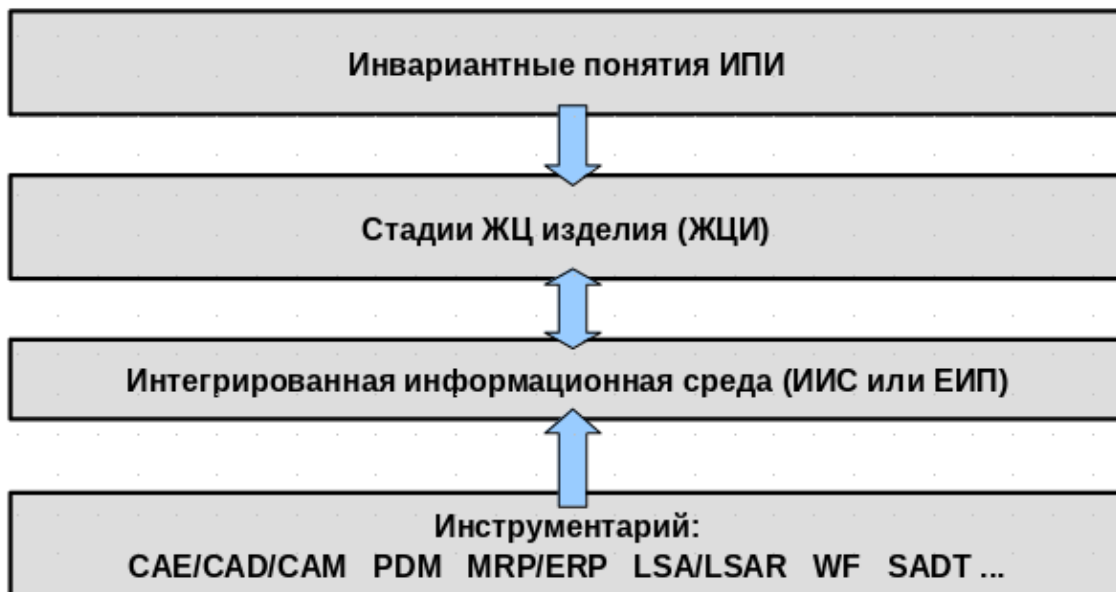
Рисунок 1.5 — Иерархическое представление концепции CALS-технологий
