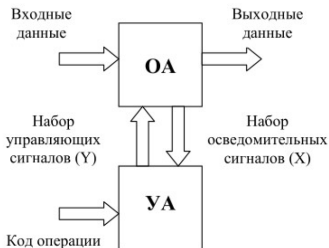
Рисунок 2.4 — Структурная схема цифрового автомата В.М. Глушкова [35]
