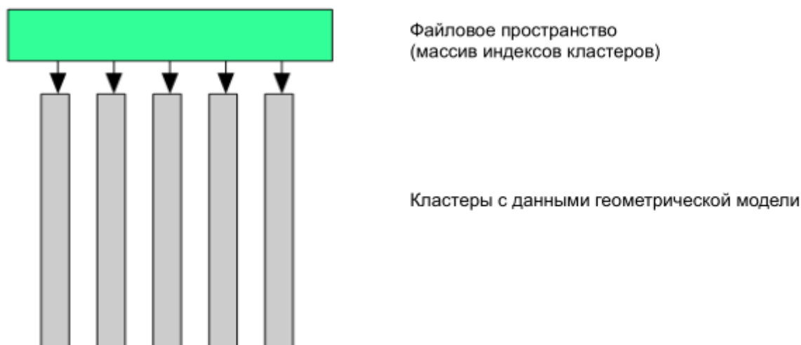
Рисунок 4.1 — Структура данных в файловом пространстве (компактный формат) [72]
