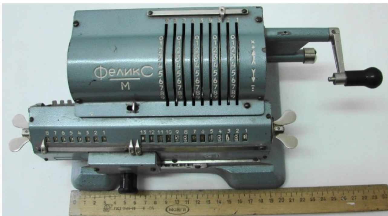
Рисунок 2.20 — Механический арифмометр «Феликс М» (Интернет)
